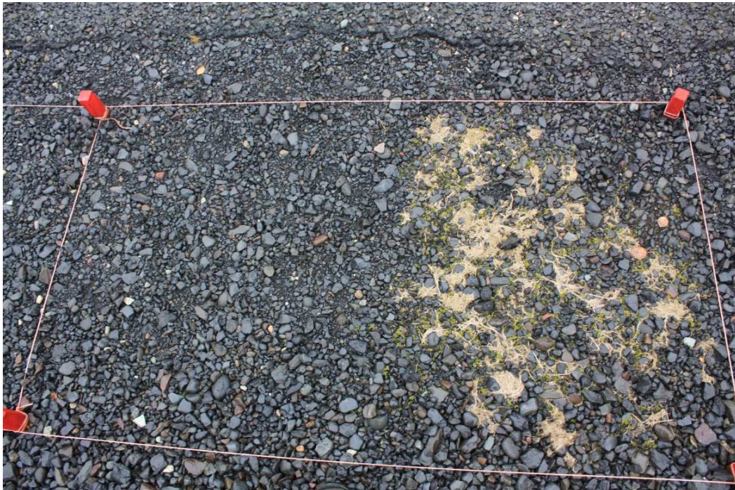
13. mynd Tilraunareitur í mosadreifingartilraun í stígganti göngustígs að Skaftafellsjökli. Mosabrotum var dreift í allan reitinn í september 2012 en slægjuþakningu aðeins í þann helming reitsins sem er til hægri á mynd. Mosabrotin hafa fest sig og vaxið þar sem þakning var til staðar en í mjög litlum mæli þar sem hún var ekki. Mynd tekin 30.september 2013.
